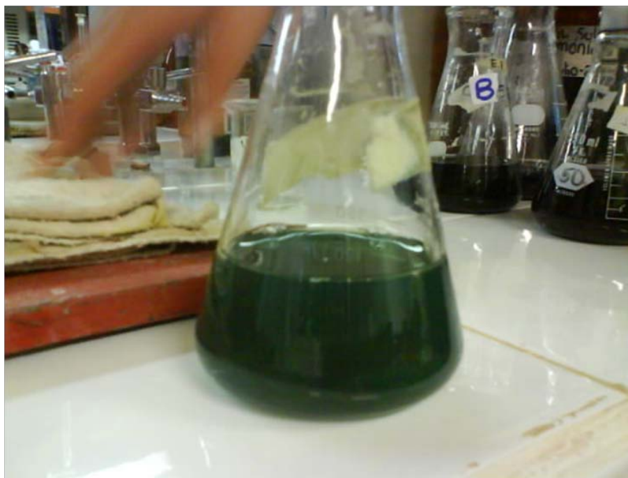
Figura 16. Imagen fotográfica del vire de color café a verde al valorar con \text{FeSO}_4 para la determinación de MO.
