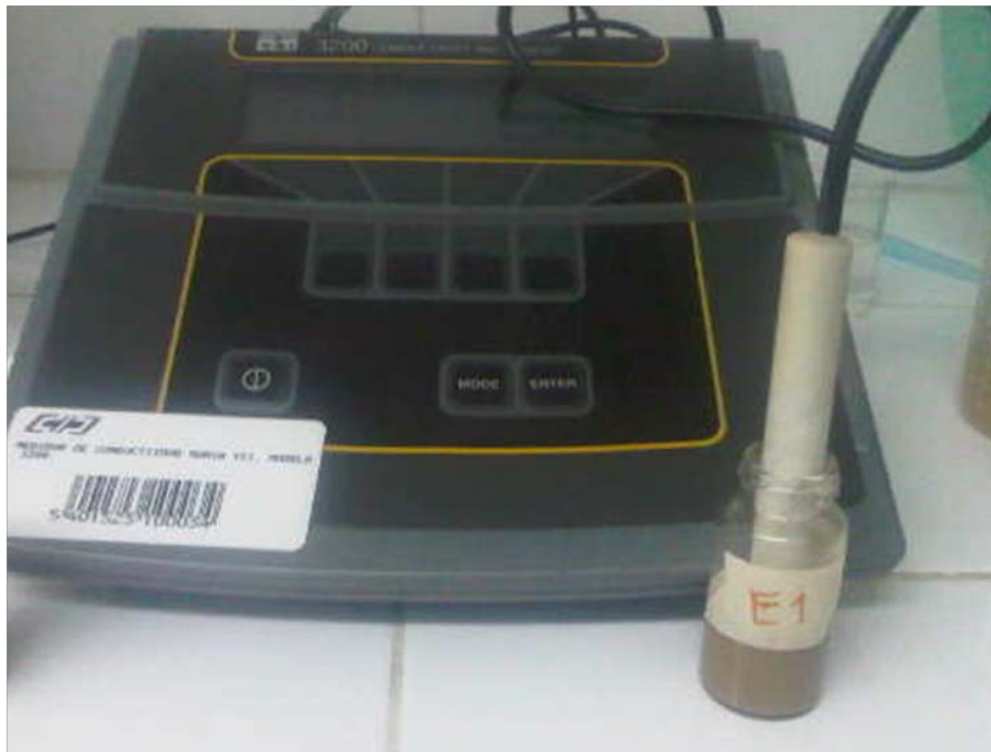
Figura 17. Imagen fotográfica de la medición de la conductividad eléctrica del suelo (sobrenadante).
