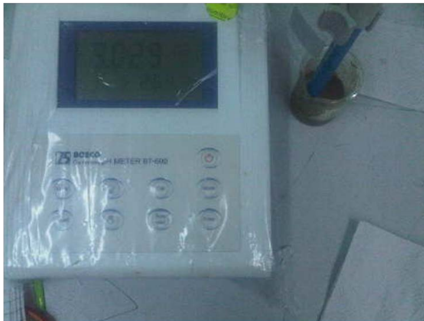
Figura 14. Imagen fotográfica de de la determinación de pH en suelo.
