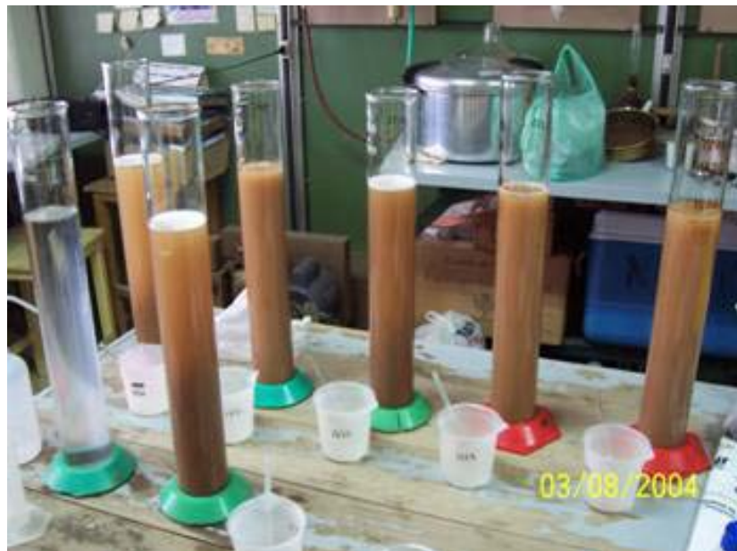
Figura 13. Imagen fotográfica de las probetas de Bouyoucos para la determinación de textura del suelo.
