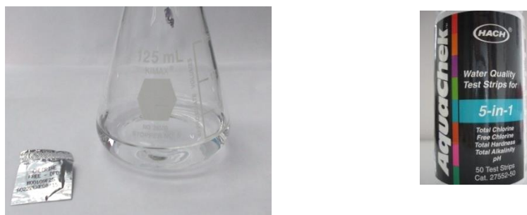
Figura A-5. Reactivo DPD y tiras para medir cloro libre
