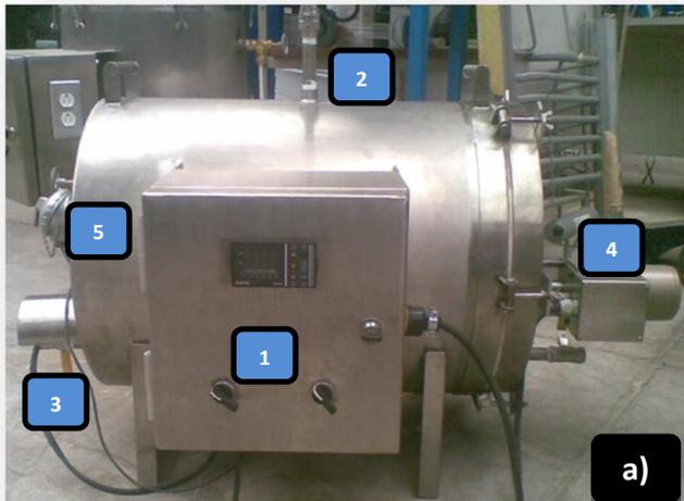
a) 1) Panel de control de agitación y temperatura, 2) puesto de muestreo y medición de biogás, 3) válvula de muestreo y purga, 4) sistema de agitación, 5) tanque de 30 L.
