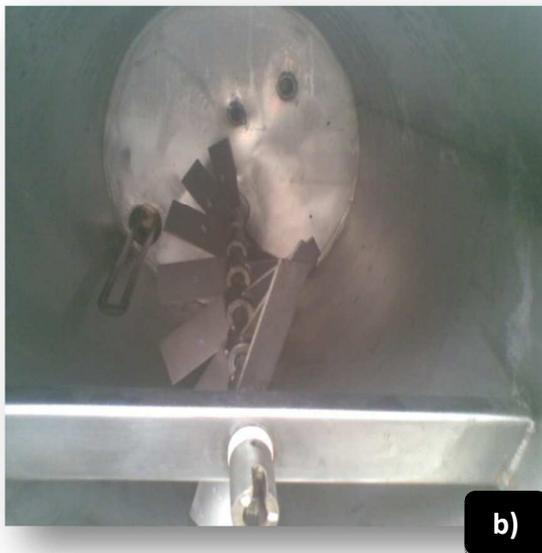
b) Parte interna del biodigestor en donde se observa el sistema de agitación con 16 aspas en forma de gusano.
