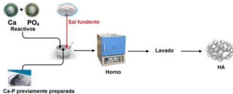
**Figura 1.** Preparación de HA a través de la síntesis de estado sólido.
