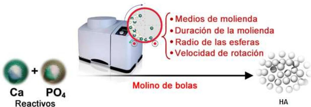
Figura 2. Preparación de HA a través del método mecanoquímico.
