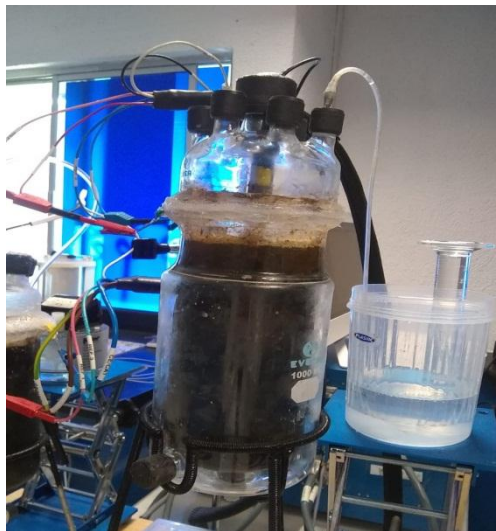
Figura 19. Instalación anexa al birreactor para colección de biogás por el método de la probeta invertida.
