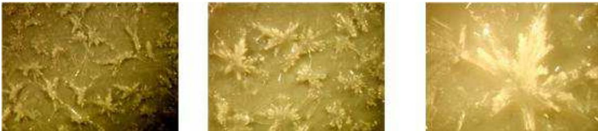
Fig. Micrografía de la muestra B sobre acrílico presentando crecimientos de cristales de titania.
