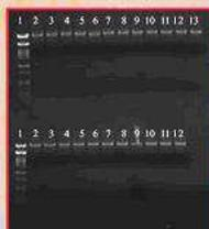
Fig. 1. DNA Genómico de microorganismos aislados de biopelículas de cantera. Carril 1: Marcador de Tamaño Molecular (DNA del fago  $\lambda$ ), digerido con Pst I. Panel Superior, Carriles 2-13: H1, H2, H3, H4, H5, H6, H7, H9, H10, H12, H13 y H14 respectivamente. Panel Inferior, Carril 1: MTM (x) + Pst I, Carriles 2-12: H15, H16, H17, H18, H19, H20, H21, H23\*, H24, H25 y H26 respectivamente. Gel de agarosa al 1% teñido con Bromuro de Etdio, obtenido por electroforesis.
