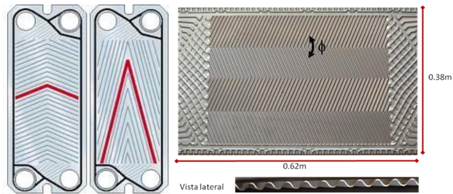
Figura 13. Placa de absorción esquema y dimensiones
