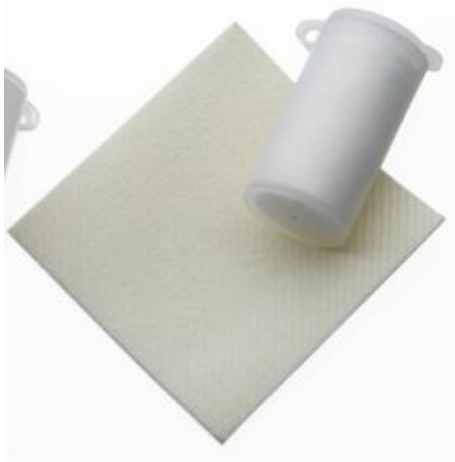
Figura 18.- Kit de pulido (Alúmina 0.5 \mu m)
