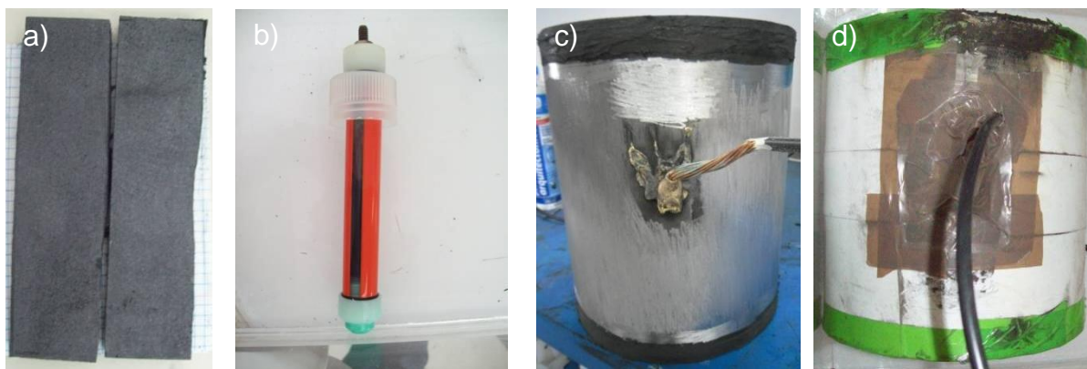
Figura 11. Electrodo utilizados: a) Placas de grafito, b) Cu/CuSO 4 , c) Ducto sin recubrimiento y d) Ducto con recubrimiento.
