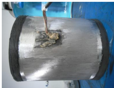
Figura 17. Ducto sellado y lijado.
