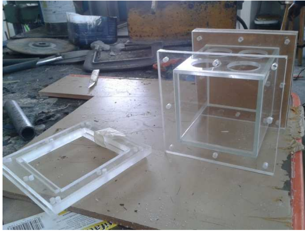
Figura 1. CCM tipo cúbica, de una sola cámara.
