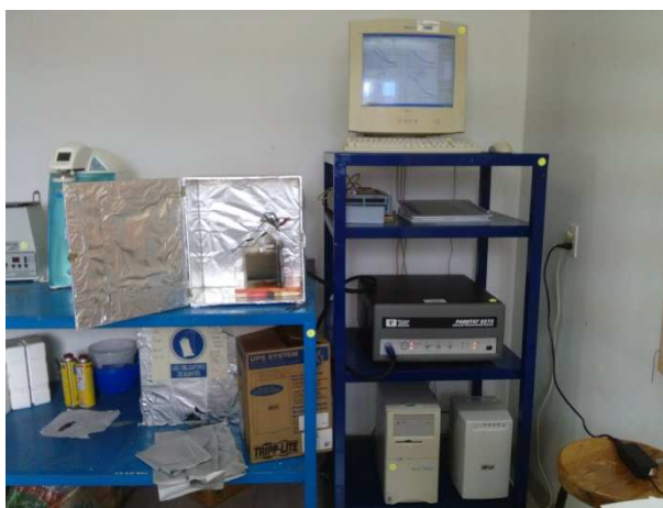
Figura 9. Potenciostato PAR conectado a una PC mediante el software PowerSuite.
