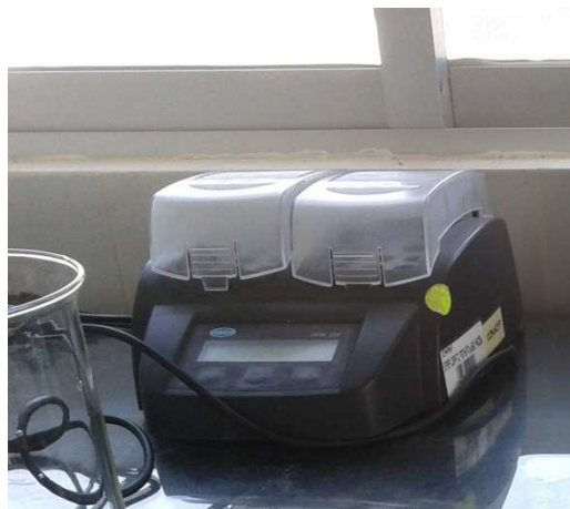
Figura 4. Digestor para la determinación de la DQO.
