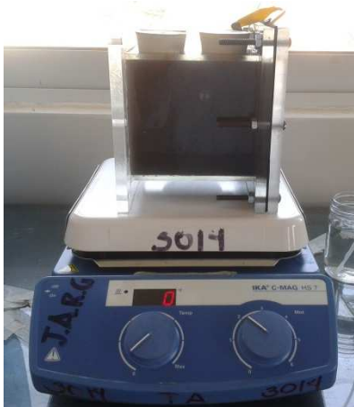
Figura 11. Parrilla de agitación para asegurar la homogeneidad dentro de la CCM.
