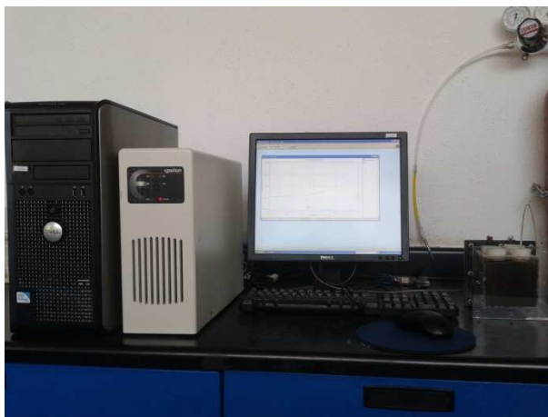
Figura 8. Potenciostato EPSILON conectado a una PC mediante el software BAS Epsilon.
