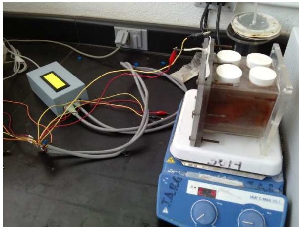
Figura 15. Sistema de adquisición de datos conectado a la CCM.
