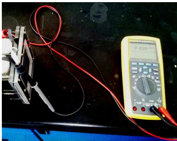
Figura 7. Multímetro para el seguimiento de la energía eléctrica obtenida con la CCM.
