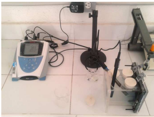
Figura 13. Potenciómetro para la medición periódica de pH y conductividad.
