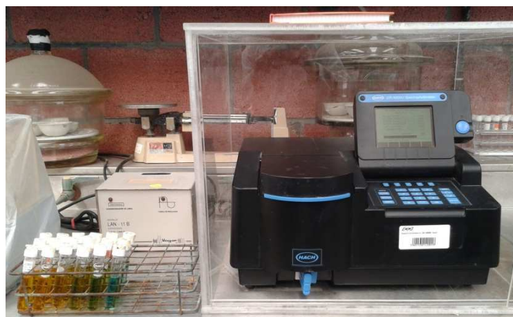
Figura 5. Espectrofotómetro para la lectura de los valores de DQO.
