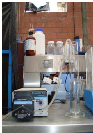
Figura 6. Bomba peristáltica para la alimentación de la biomasa.
