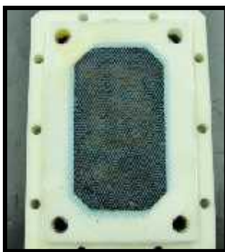
Figura 3.35. Depósito sobre cátodo con promotor de turbulencia atrapado.
