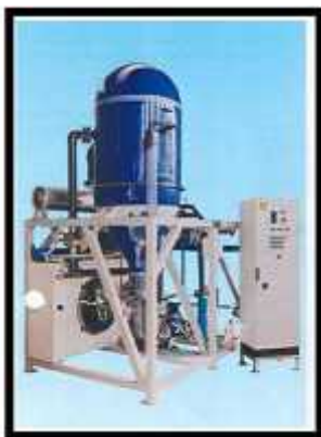
Figura 1.3. Equipo de cristalización por evaporación de baños agotados.
