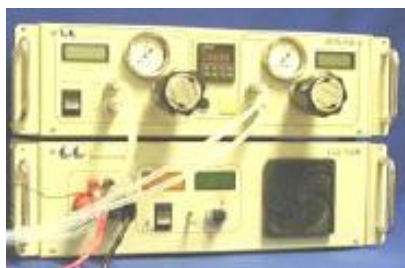
Figura 3.12. Equipo para el control de operación de las CCEPS, Electrochem® ECL-150 y MTS-150
