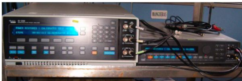
Figura 3.11. Interfase electroquímica analizador Solartron® 1260 y analizador Solartron® 1287
