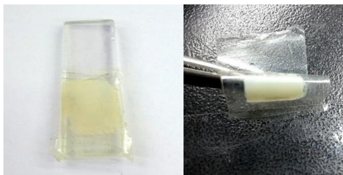
Figura 10. Configuración del electrodo de trabajo (MNTs- \text{TiO}_2 soportada en vidrio ITO).
