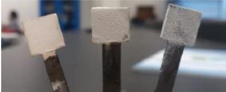
**Figura 26.** Electrodos recubiertos a 300 V (20, 30 y 15 min).
