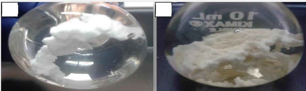
**Figura 27. Polimerización química de la Anilina al contacto con el medio ácido. En la imagen A, la concentración del ácido es de 0.8M. En la imagen B, la concentración del ácido es de 0.6M.**
