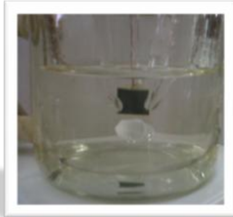
Figura 1 Fotografía de la celda electrolítica con la solución de NaCl 5%wt y la placa de acero con el recubrimiento de Zn antes de iniciar el experimento.
