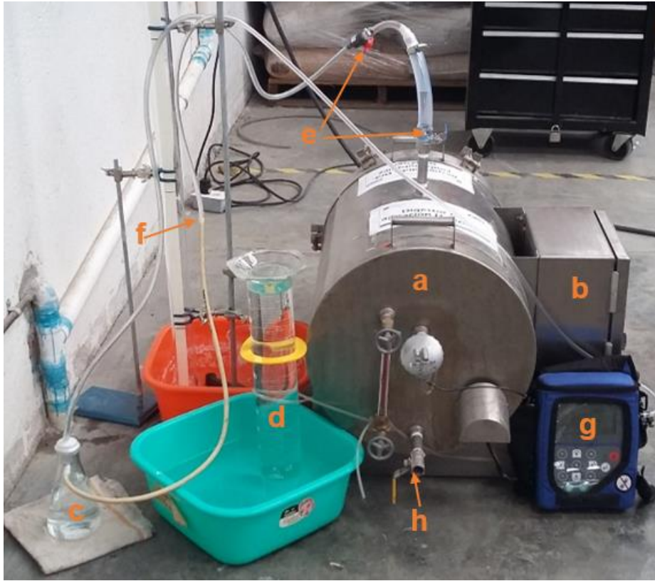
Figura 8. Montaje del Biodigestor con sistema de medición de gas por el método volumétrico.
