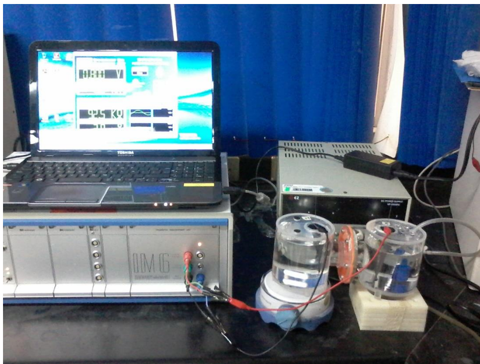
Figura 5.3. Conexiones para el análisis de impedancia en celda completa.
