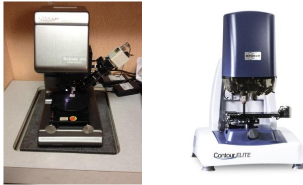
Figura 34. a) Perfilómetro Veeco Dektak 6M, b) microscopio óptico 3D marca Bruker.
