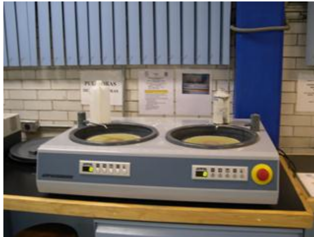
Figura 28. Máquina pulidora marca Buehler.
