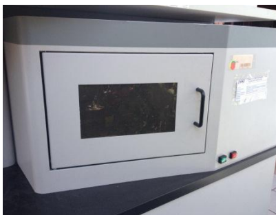
Figura 36. Espectrofotómetro GDOES-850A LECO.
