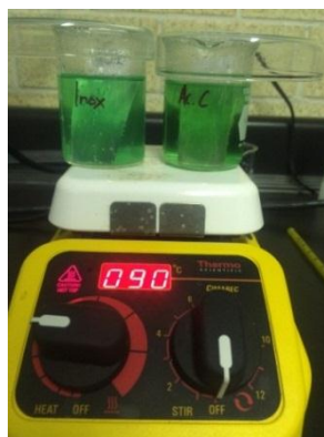
Figura 30. Preparación de recubrimientos Ni-P vía electroless.
