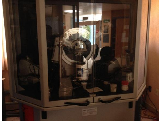
Figura 32. Difractómetro de rayos X Bruker AXS.
