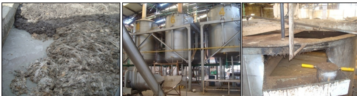
Figura 1.2 Proceso de la industria del descarte: a) recolección de residuos de curtiduría (materia prima), b) ollas de cocción para obtención de sebo y c) sebo resultante o sobrenadante en las ollas de cocción.
