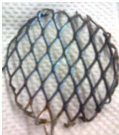
Figura 9.10 Electrodo de malla de titanio pasivado después de ser utilizado como ánodo.
