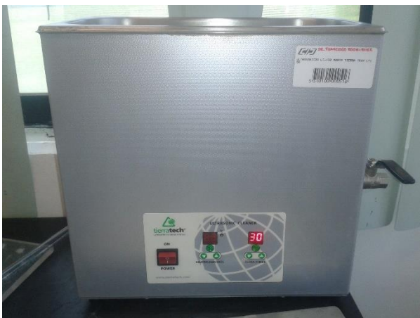
Figura 6.8 Sonicador por ultrasonido.
