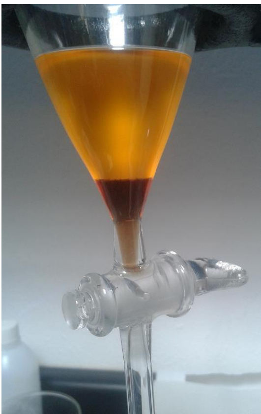
Figura 6.16 Arriba se aprecia el biodiesel generado, abajo se aprecia la glicerina que es un subproducto de reacción.
