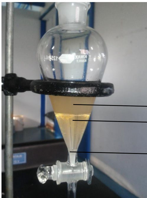
Figura 6.11 Separación de fases de biodiesel por gravedad.
