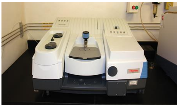
Figura 6.6 Espectrofotómetro de Infrarrojos (FT-IR).
