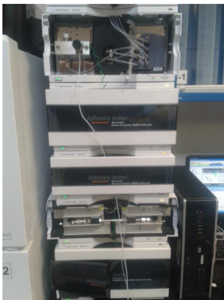
Figura 6.3 Cromatógrafo líquido empleado en laboratorio.
