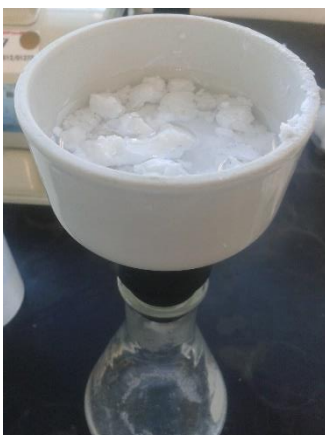
Figura 6.15 Filtración y lavado de catalizador.
