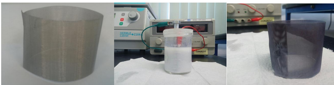
Figura 6.7 Deposito de \text{TiO}_2 por electroforesis.
