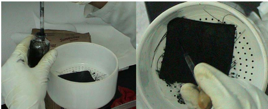
Figura 3.4.1. Acondicionamiento de difusores, la mezcla Teflon ® / Vulcan se agrega a la tela de carbón por filtrado al vacío.
