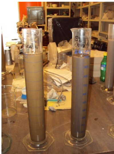
Figura 5. 4. Determinación de textura.
