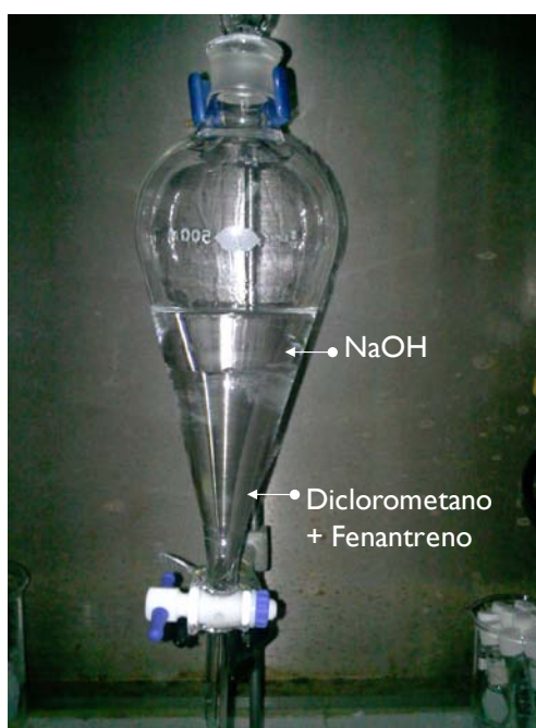
Figura 5. 6. Montaje experimental empleado para hacer una separación líquido-líquido.
