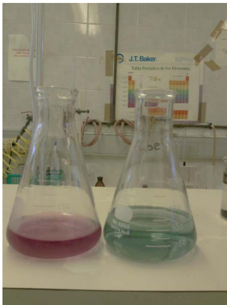
Figura 5. 1. Vire de color de rosa a verde para medir la capacidad de intercambio catiónico.
