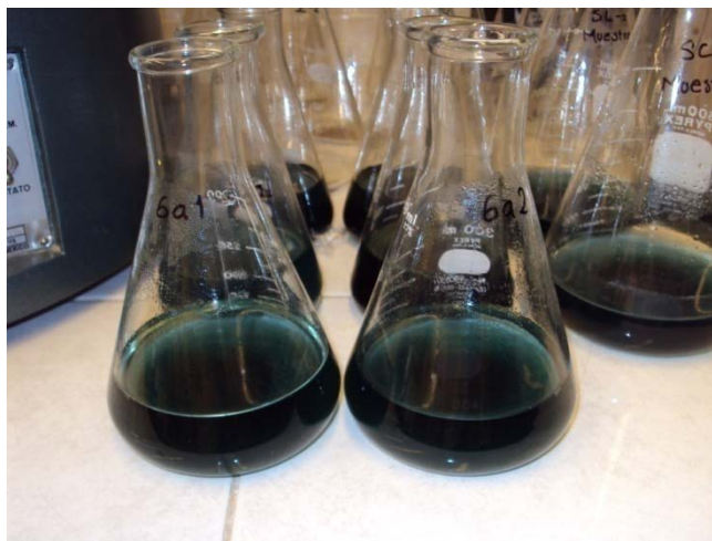
Figura 5. 2. Vire de la solución a color verde para cuantificar la materia orgánica por el método de Walkley- Black.
