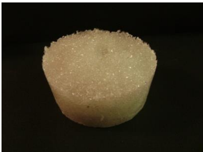
Figura 8. Estructura tipo ópalo de poliestireno molido.
