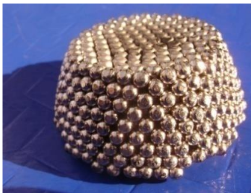
Figura 12. Estructura tipo ópalo metálico vidrio-Ni.
