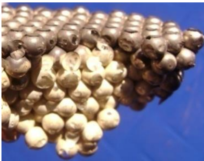
Figura 13. Interior de la estructura tipo ópalo de vidrio-Ag-Ni.
