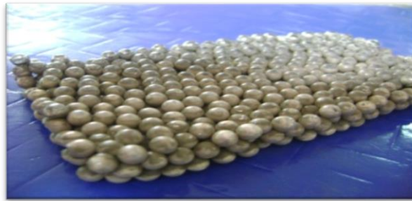
Figura 11. Estructura tipo ópalo de plata
