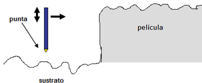
Figura A-7. Esquema de funcionamiento de un perfilómetro.
