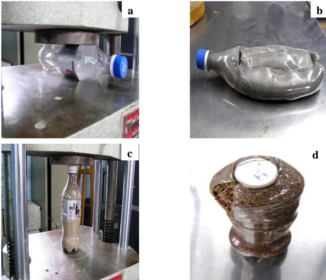
**Figura 8.** Forma general de compactación y aparición de falla típicas: a) Botella en forma horizontal antes de la prueba de compresión, b) Botella en forma horizontal después de la prueba de compresión, c) Botella en forma vertical antes de la prueba de compresión, d) Botella en forma vertical después de la prueba de compresión
