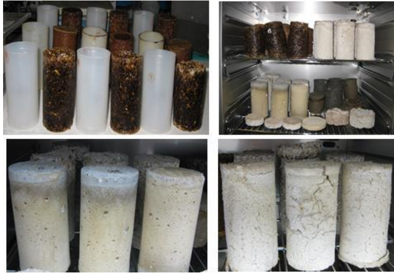
Figura 2.17 Muestras desmoldadas y colocadas en la mufla para tratamiento térmico 150°C por 2 h.
