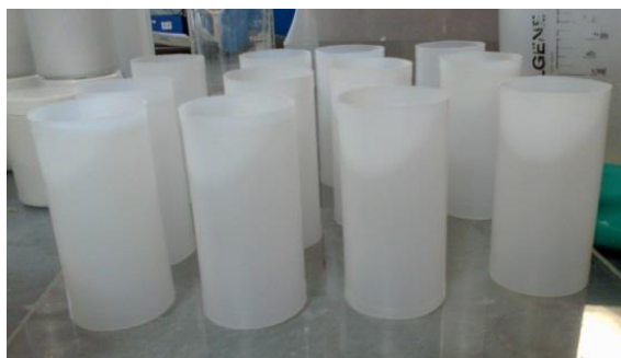
Figura 2.12 Moldes 5cm \varnothing x 10cm para todas las muestras.
