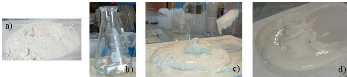
Figura 2.6 Proceso de elaboración del geopolímero. a) Mezcla de Metasilicato y Metacaolín, b) Mezcla de NaOH + H 2 O, c) Consistencia después de mezclar todos los componentes y d) Consistencia final del producto.
