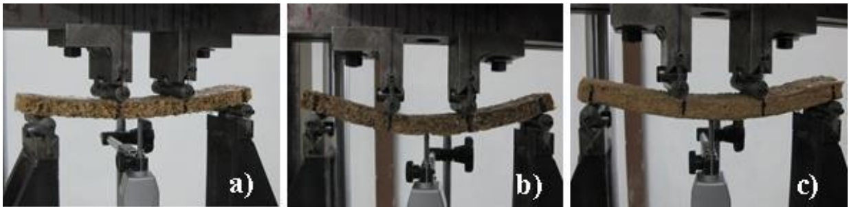
Figura 3.10 Flexión UREA. a) Urea – Cascarilla de Café, b) Urea – Cascarilla de Cebada y c) Urea – Cascarilla de arroz.
