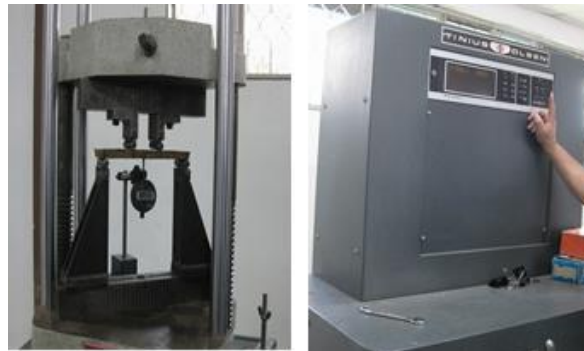
Figura 2.21. Máquina Universal utilizada en ensayo de flexión.
