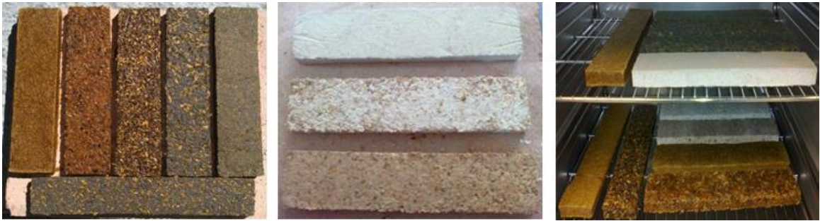
Figura 2.18 Muestras elaboradas para ensayo de flexión.
