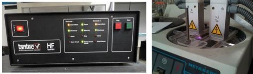
Figura 2.22 Equipo Corona para aplicar descargas eléctricas.
