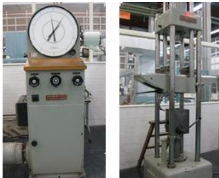
Figura 2.19 Máquina Universal con la que se llevó a cabo el ensayo de compresión.
