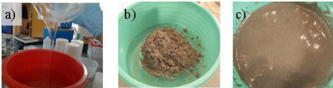
Figura 2.8 a) Sol-gel a base de Si (matriz 1). b) Adición de la Ceniza Volante. c) Producto final de la mezcla.
