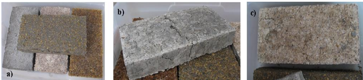
Figura 3.34 a) Muestras finales antes del tratamiento y b) y c) muestras después del tratamiento térmico.
