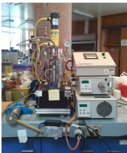
Figura 2.23 Reactor de fluidos supercríticos, empleado en el proyecto.
