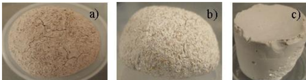
Figura 2.4 a) y b) Geopolímero con cascarilla de arroz, seco a temperatura ambiente y adicional un tratamiento térmico. c) Geopolímero puro seco a temperatura ambiente sin tratamiento térmico.
