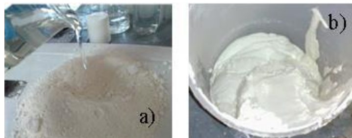
Figura 2.7 a) Adición del Sol-gel al metacaolín. b) Producto final obtenido del geopolímero con Sol-gel como fuente de Si.
