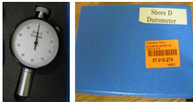
Figura 2.20 Durómetro portátil escala Shore D.
