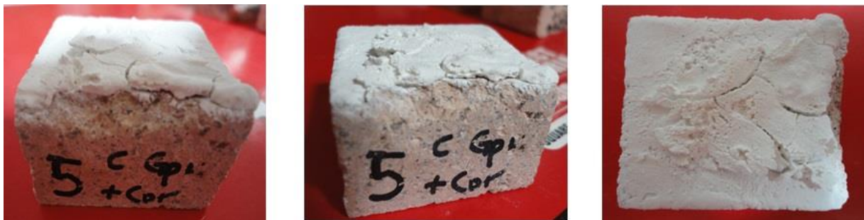
Figura 3.24 Cantera rosa con adición de geopolímero y aplicación de método corona.
