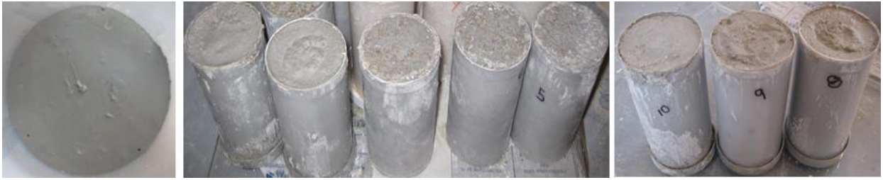
Figura 2.15 Muestras elaboradas con la matriz SG/GP/CV y las tres cascarillas diferentes.
