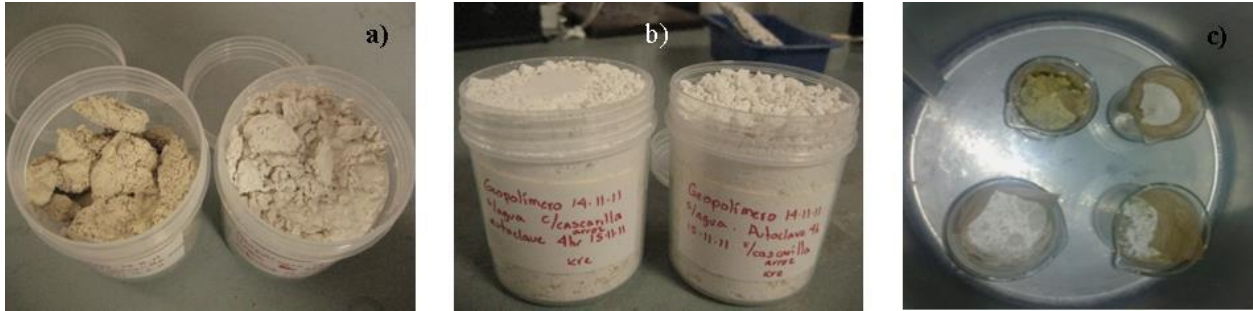
Figura 3.27 a) Geopolímero con y sin cascarilla, b) Componentes del geopolímero con y sin cascarilla
