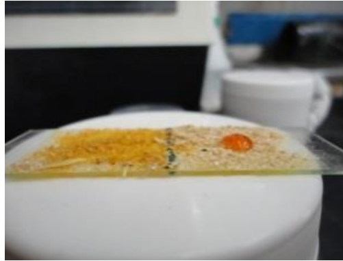
Figura 3.23 Cascarilla de arroz con tratamiento y sin tratamiento corona (respectivamente), con colorante en la superficie.
