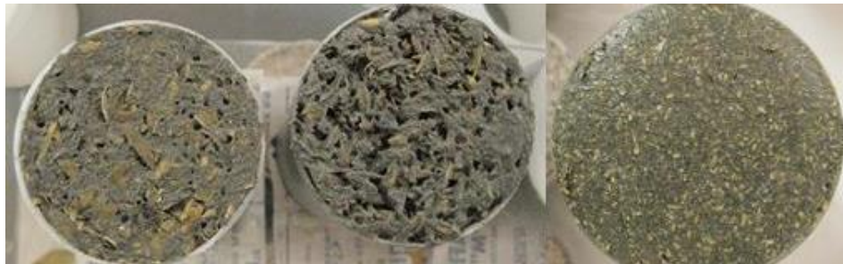
Figura 2.16 Muestras elaboradas con la matriz CV/SG y las tres cascarillas.
