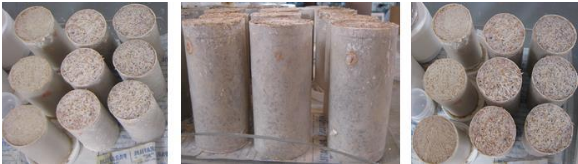
Figura 2.14 Muestras elaboradas de GP con las tres diferentes cascarillas.
