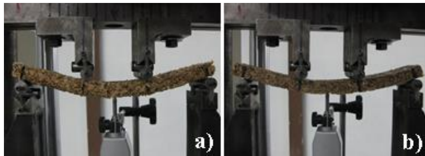
Figura 3.11 Flexión PVA. a) PVA – Cascarilla de Café y b) PVA – Cascarilla de cebada.
