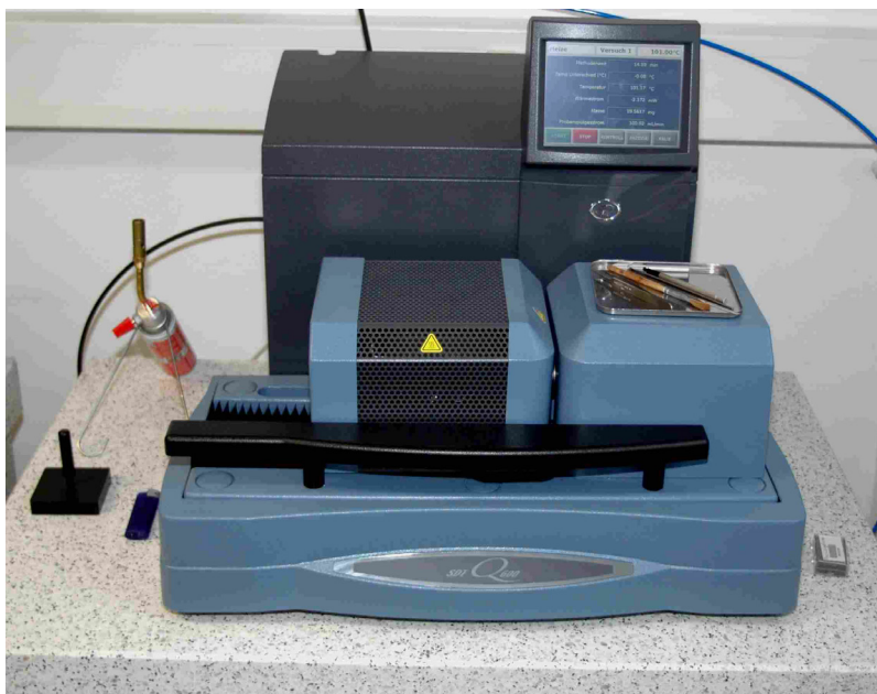
Figura 7.3. Equipo de análisis termogravimétrico diferencial, Simultaneous DSC/TGA SDT Q600 V8.3 de TA Instruments.
