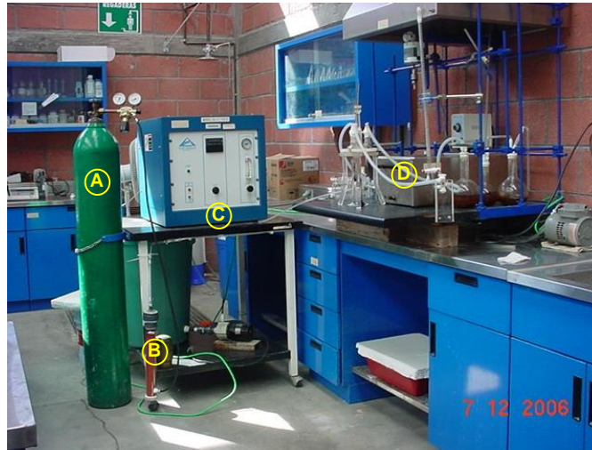
Figura III.1. Equipo para la síntesis de un material formado por OMD en AC.
