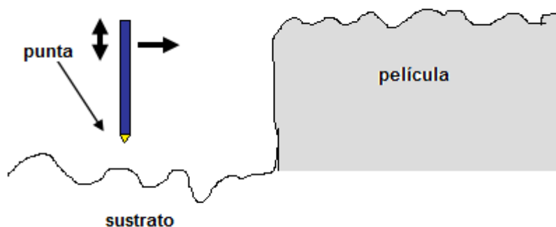
Figura 65. Esquema del perfilómetro
