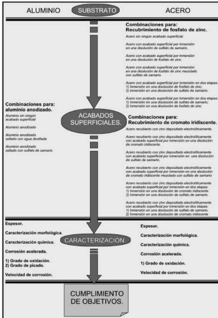
Figura 44.- Diagrama experimental del estudio del sellado de los recubrimientos anticorrosivos con sulfato de samario.
