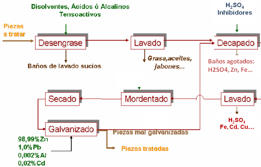
Figura 2. Diagrama de flujo del proceso de galvanizado en caliente por inmersión.
