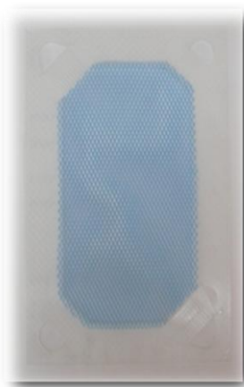
Figura 20. Promotor de turbulencia utilizado (polietileno).
