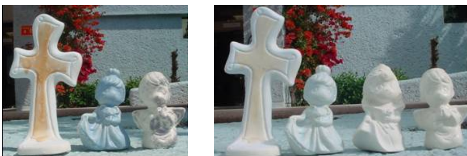
Figura 3.1. Imágenes de los recubrimientos fotocromicos a) al exponerse a luz solar, b) al retirarse.
