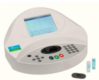
Tabla 3.4 Espectrofotómetro UV - Visible marca Perkin Elmer.
