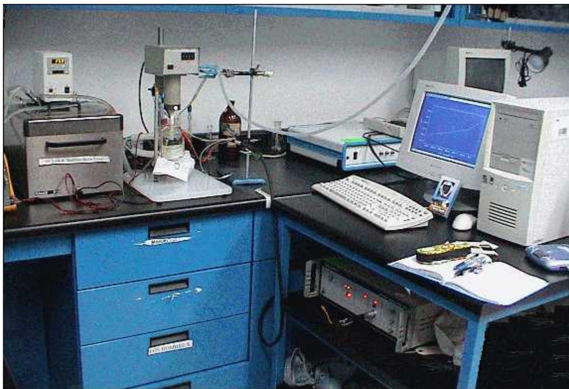
**Foto 4.2** Montaje del equipo del Electrodo de Disco Rotatorio, con el potenciostato/galvanostato y una PC para adquisición de datos.
