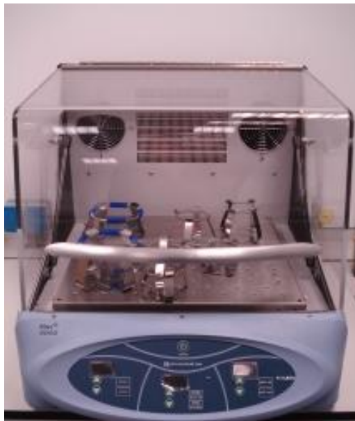
Figura 4.5 Agitador orbital con incubadora utilizado controlar la temperatura del proceso biológico en la primera etapa del proyecto
