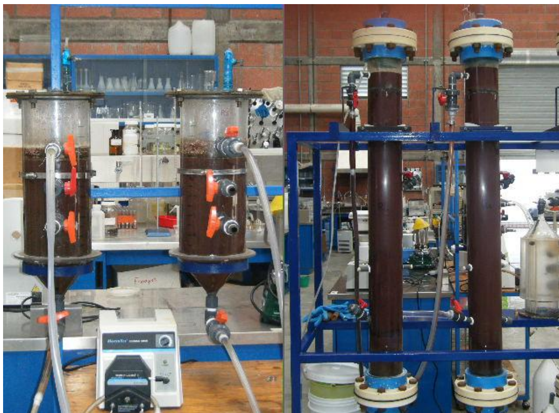
Figura 4.8 Sistema anaerobio de dos etapas: la imagen de la izquierda es la que corresponde a la etapa de fermentación y la de la derecha es la etapa de metanización
