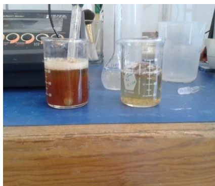
Figura 22.-a) Neutralización de las muestras usando \text{NaOH} b) Filtrado de las muestras para remover los lodos.
