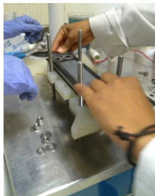
Figura 26.-Armado de celda e instalación de los electrodos.
