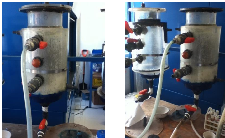
Figura 17.-Tratamiento de aguas residuales en Reactor UASB escala laboratorio 7(L).
