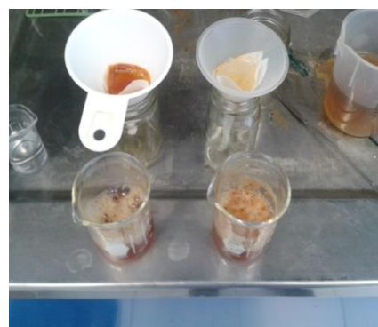
Figura 22.-a) Neutralización de las muestras usando \text{NaOH} b) Filtrado de las muestras para remover los lodos.
