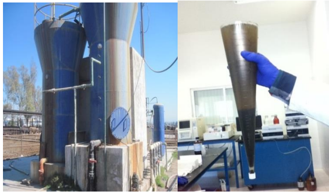
Figura 15.-Tratamientos preliminares de la muestra de agua residual.
