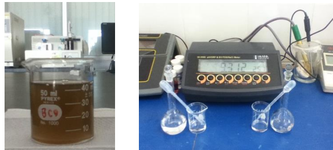
Figura 20.-Ajuste de pH del efluente con H_2SO_4 5M.
