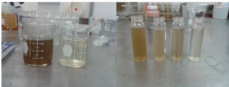
Figura 33.-a) Muestra antes y después de la aplicación del tratamiento Electrofenton 0.7mM b) Muestras tomadas por tiempos en el tratamiento Electrofenton 0.7 mM
