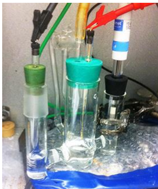
Figura 4.5 Celda de 3 compartimentos donde se llevó a cabo la caracterización electroquímica.
