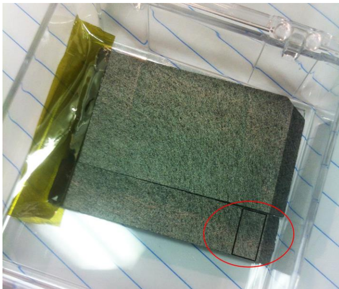
Figura 4.6 Muestra de un electrodo utilizado para la caracterización electroquímica.
