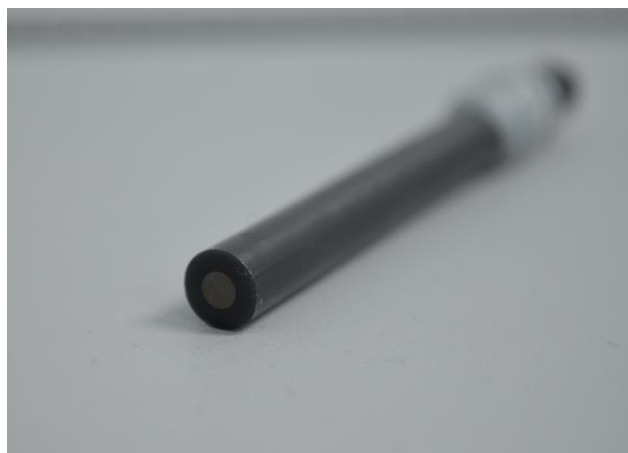
Figura 3.2 Electrodo de carbón vítreo (GCE) utilizado para realizar los electrodepósitos de Pt y Ag ( A=0.071\text{ cm}^2 ).
