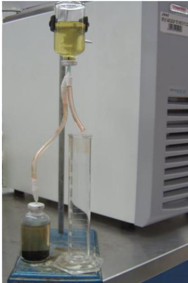
**Figura 6.1.** Sistema de medición de metano por desplazamiento volumétrico.
