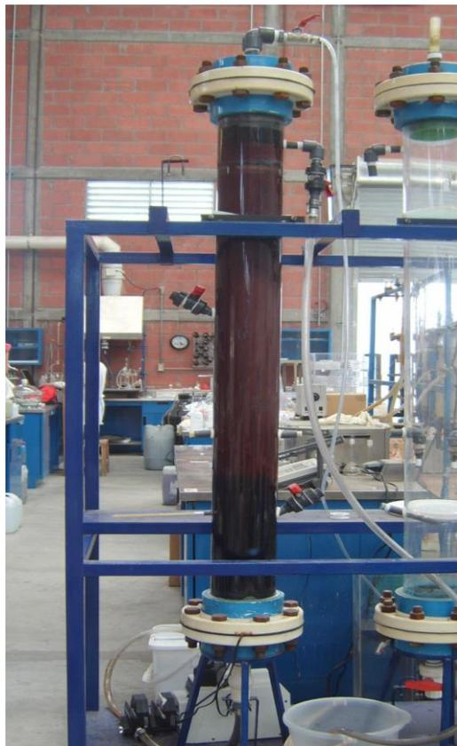
**Figura 6.7.** Reactor anaerobio de flujo ascendente (UASB) utilizado para las pruebas en continuo.
