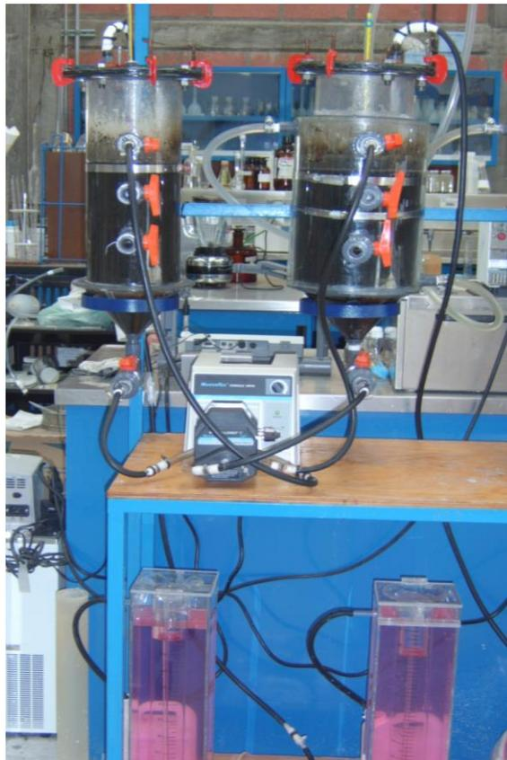
**Figura 6.6.** Reactores anaerobios utilizados para el comparativo de temperaturas.
