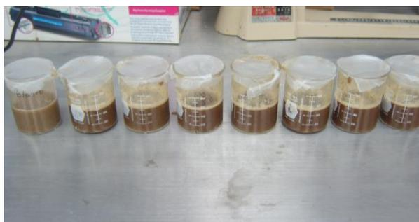
**Figura 6.5.** Pruebas de solubilización con diversas dosis de NaOH.
