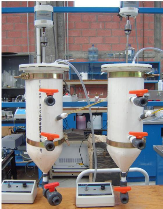
**Figura 6.4.** Reactores anaerobios de mezcla completa utilizados para el comparativo entre diferentes cargas de sólidos.
