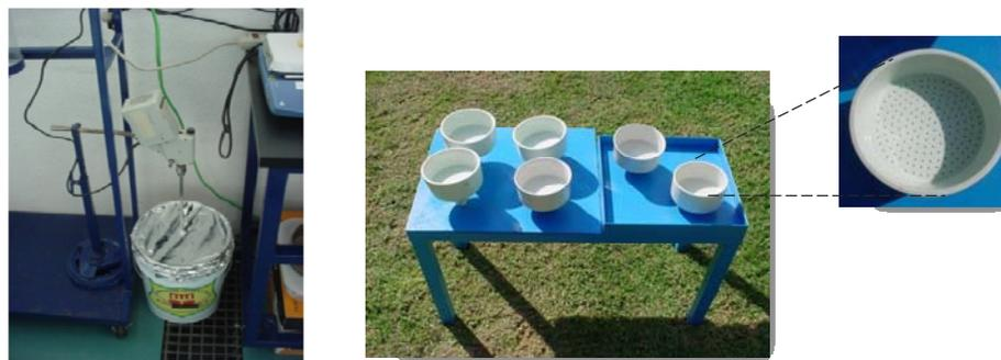
Figura 8.33. Uso de miniceldas de alteración en la evaluación del efecto de estabilización de lodos composteados sobre los EPT presentes en jales mineros.
