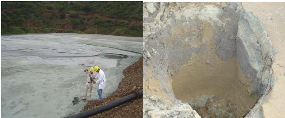
Figura 7.4. Toma de muestra en la presa de jales Las Torres fuera de operación
