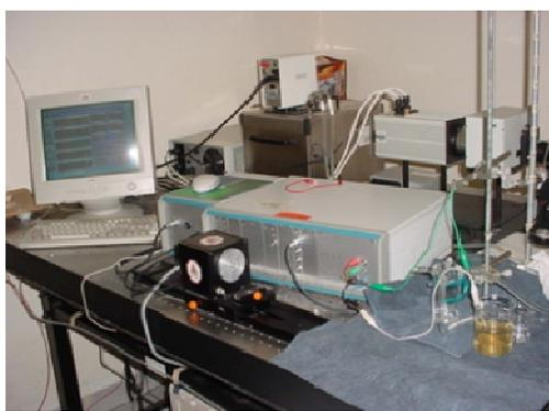
Figura 7.11. Instrumentos de medición del Potencial de Óxido-Reducción.
