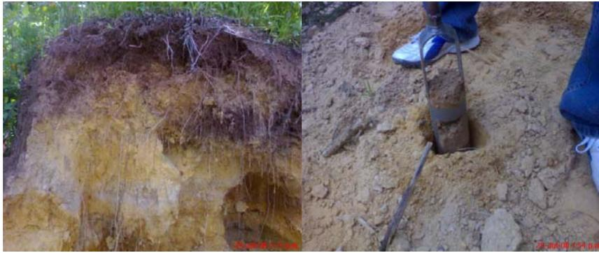
Figura 7.5. Toma de muestra en la presa de jales fuera de operación Pozuelos
