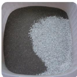
Figura 7.9. Grava y arena empleada como soporte en las pruebas de lixiviación.
