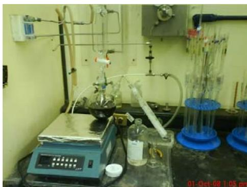
Figura 7.6. Equipo para la determinación de cianuros reactivos.
