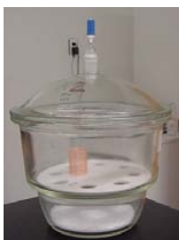
Desecador con electrodo durante el proceso de peso constante una vez que se llevó a cabo el depósito.
