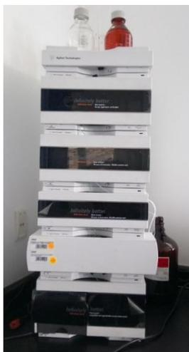
**Figura 6. Cromatógrafo de líquidos (HPLC).**
