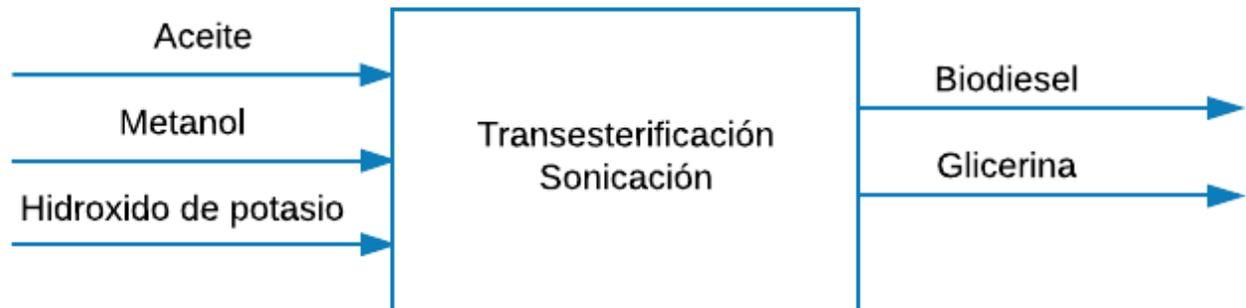
Figura 14. Diagrama de entradas y salidas en el proceso de producción de biodiesel.
