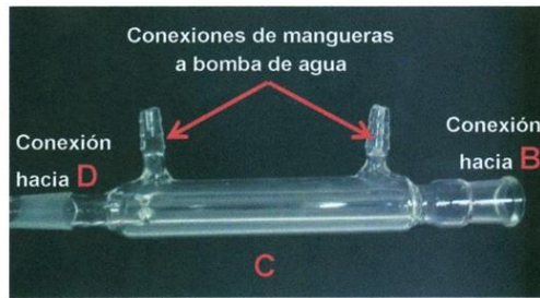
Figura 6. Condensador del producto metálico de la extracción.
