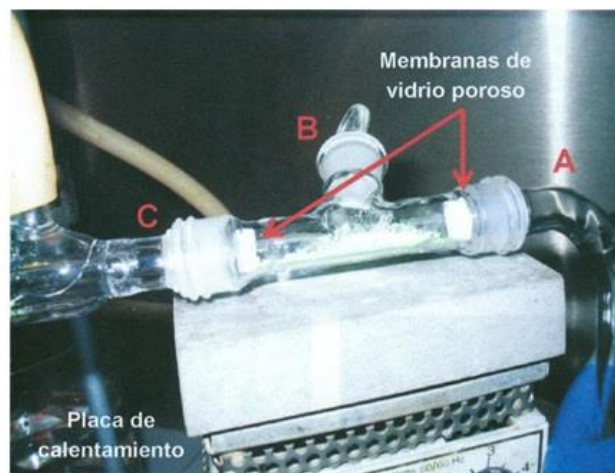
Figura 5. Reactor para la extracción gaseosa de metales, contiene al sólido sostenido por dos membranas que permiten el flujo del gas.
