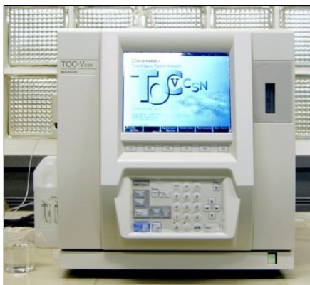
Figura 22. Imagen fotográfica de un equipo TOC, modelo Schimadzu TOC-V CSN [82].
