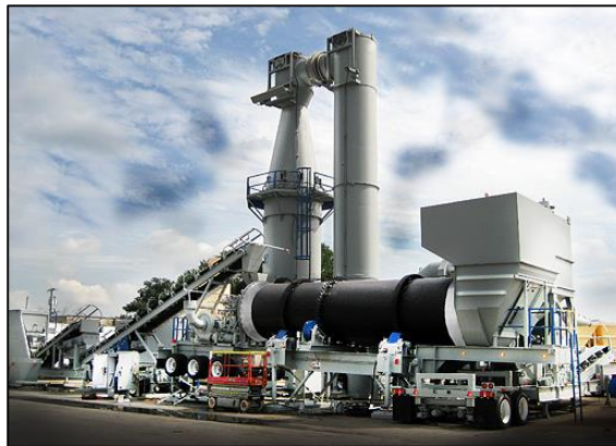
Figura 6. Imagen fotográfica de un equipo de desorción térmica de contaminantes presentes en suelo [27].
