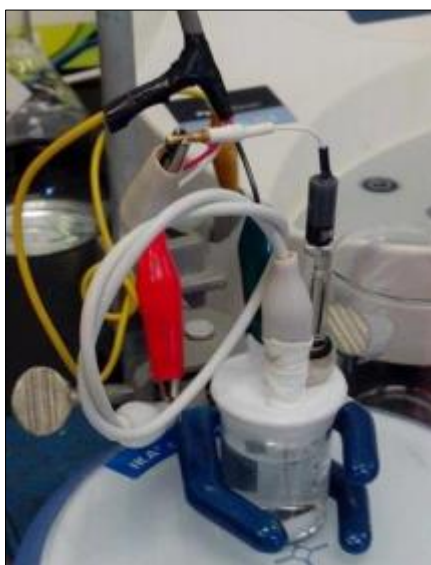
Figura 56. Imagen fotográfica del montaje de la celda electroquímica para la determinación de la ventana de potencial constituida por un electrodo de trabajo de \text{IrO}_2\text{-Ta}_2\text{O}_5|\text{Ti} (previamente activado), alambre de Pt como contra-electrodo y un electrodo de referencia de Ag/AgCl.
