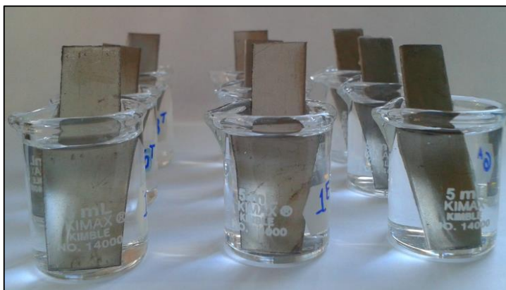
Figura 55. Imagen fotográfica de la prueba de la estabilidad mecánica y química del aislante en presencia de soluciones con diferentes valores de pH: 1, 7 y 13.
