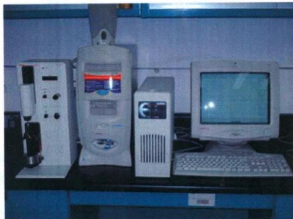
**Figura 2.31** Potenciostato acoplado al EDR para determinar los parámetros electrocinéticos.
