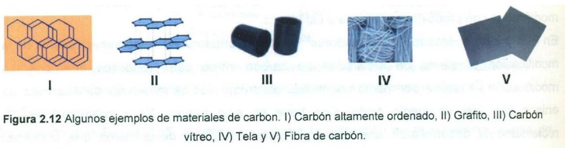
**Figura 2.12** Algunos ejemplos de materiales de carbon. I) Carbón altamente ordenado, II) Grafito, III) Carbón vítreo, IV) Tela y V) Fibra de carbón.
