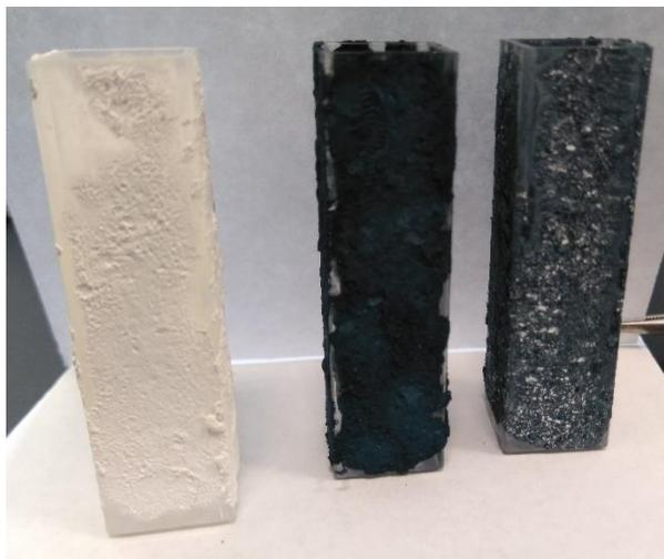
Figura 24. Celdas de PMMA con depósitos de  $TiO_2$  anatasa, magneli y anatasa/magneli.
