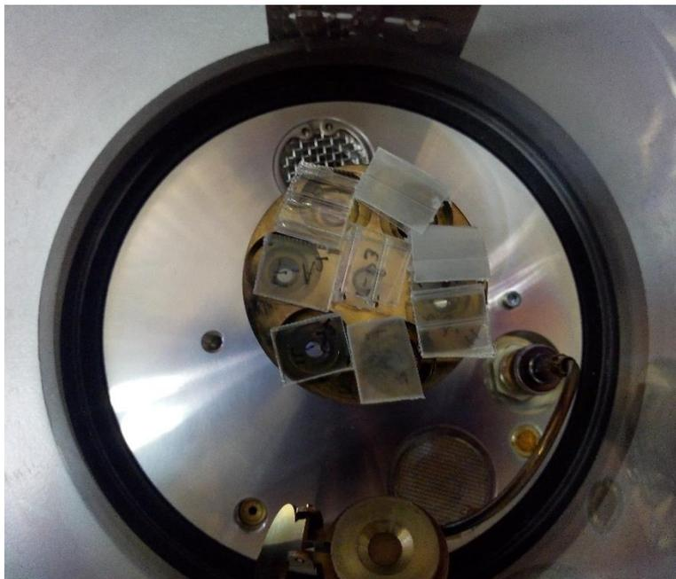
*Ilustración 44 SPI-MODULE\* Sputter Coater con el cual se recubrieron las muestras no conductoras con una capa de Au de 2nm de espesor.*
