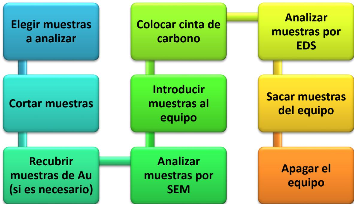
*diagrama 7 metodología general del uso y preparación de muestras para el análisis en SEM y EDS.*
