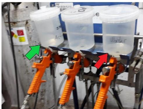
*Ilustración 7 flecha roja indicando donde se coloca el activante y la flecha verde señala donde se coloca el agua desionizada*
