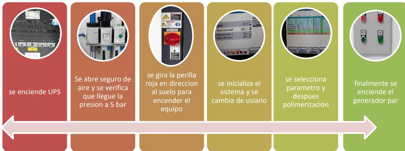
Diagrama 4 proceso de encendido del UPS
