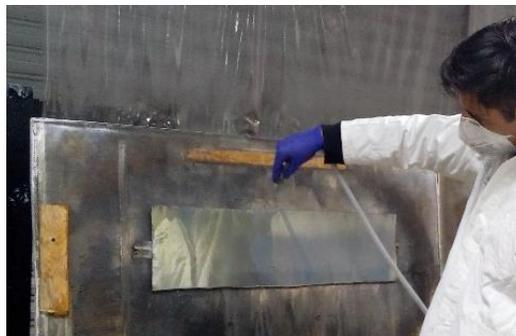
*Ilustración 10 Aplicación sobre el sustrato de la solución agente oxidante y reductor*
