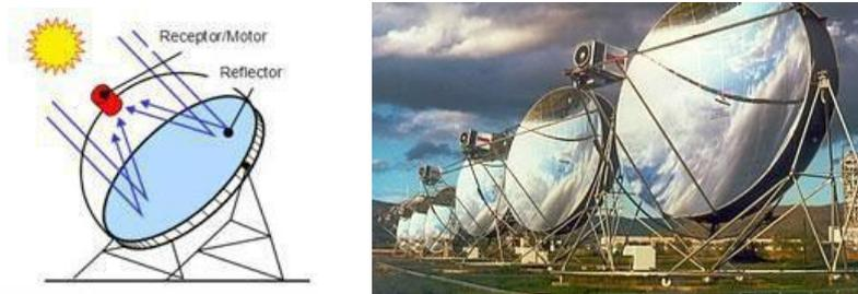
*Ilustración 2 Captación de energía solar por Disco Stirling.*
