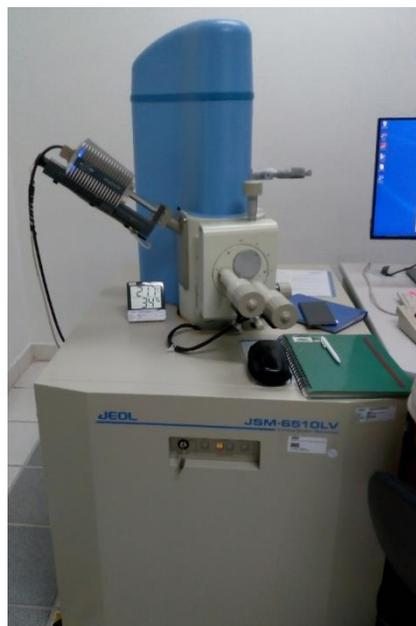
*Ilustración 42 Microscopio electrónico de barrido marca JEOL modelo JSM-6510LV y con un equipo acoplado de EDS marca BRUKER.*
