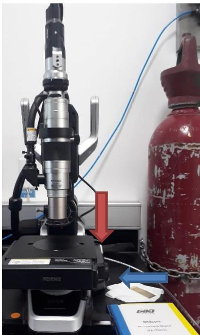
*Figura 33 ajuste de enfoque y bloqueo de platina*
