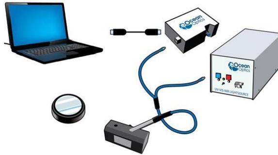
Fig. 2.2. Esquema de equipo Ocean Optics.
