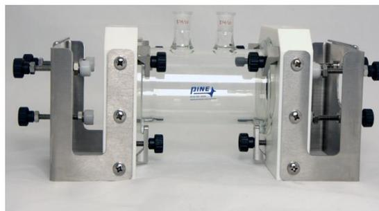
Fig. 2.3. Celda de corrosión
