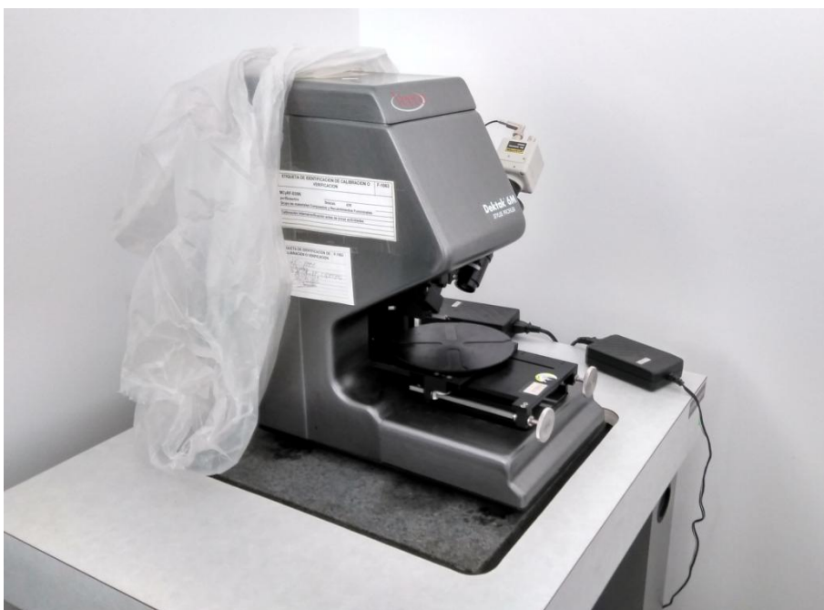
Figura 35. Perfilómetro mecánico Dektak 6M Stylus Profiler , asistido con software y un ordenador.
