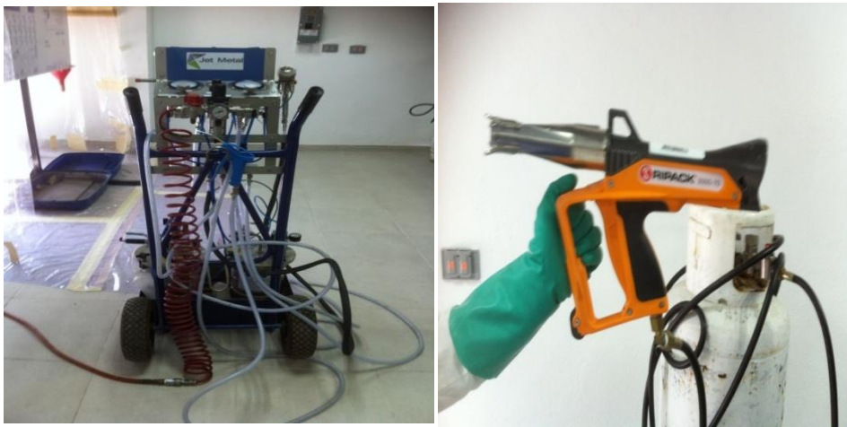
Figura 6. Estación de Espray JET METAL y Flaming encendido automático.
