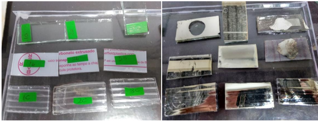
Figura 19. Nueve muestras sin recubrimiento vidrio, policarbonato transparente y policarbonato celular (izquierda), nueve muestras con los mismos sustratos metalizados con plata (derecha).
