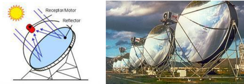
Figura 2. Captación de energía solar por Disco Stirling [Fuente: Protocolo Pre doctoral, M. en C. Montserrat Gutiérrez Muñoz].
