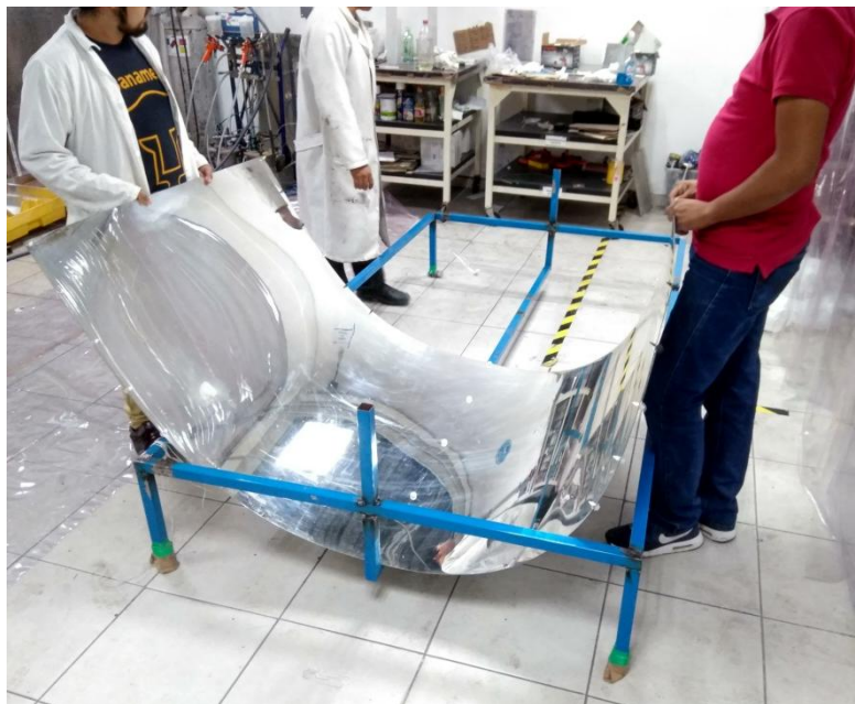
Figura 37. Montaje del concentrador de canal parabólico, utilizando un espejo plano flexible de segunda superficie, en sustrato de policarbonato transparente de 1.5 mm espesor.
