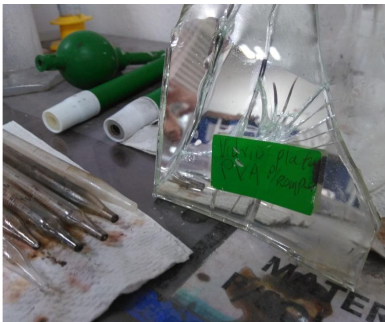
Figura 29. Muestra de sustrato de vidrio con metalizado de plata y recubrimiento protector de PVA, destinada a ser fragmentada.
